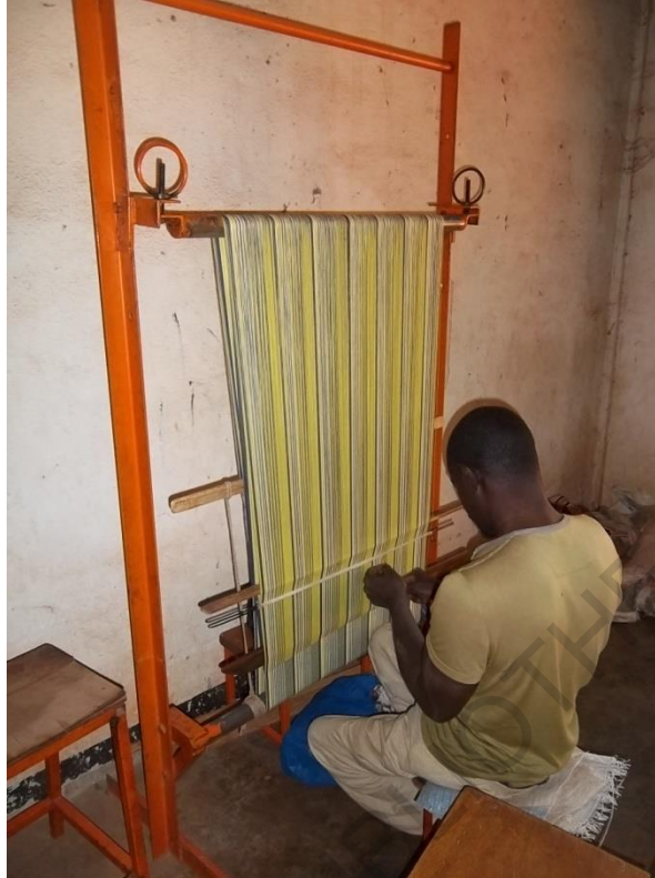
Photo n° 22 : Métier à tisser vertical au centre de formation pour handicapés de Souroukoutchin(Bobo-Dioulasso). Ici le métier est actionné par un homme
