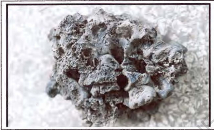
PHOTO N°42 : SCORIE DE FER N°3 : RUGUEUSE AVEC UN ASPECT POREUX PAR ENDROIT SUR LE SITE DE BANDINGUE
