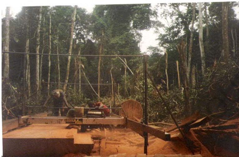
Planche 5.3. Exploitation industrielle du bois à l'aide de la Lucas Mill dans la forêt de Ntéha'a au Bosquet. (Antang, 2006)
