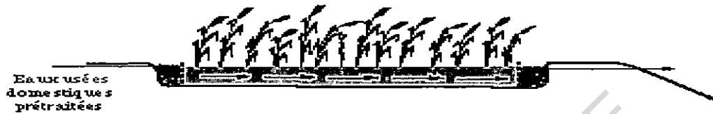
Schéma 7 : Le système KICKUTH (Michel Radoux, 2004-b).
